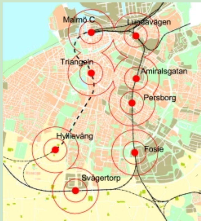
När Kontinentalbanan avlastats från dagens genomfartstrafik till Öresundsbron kan lokal tågtrafik utvecklas och nya stationer öppnas. I figuren ovan visas existerande, planerade och möjliga stationslägen. Cirklarna visar avstånden 500m och 1000m från stationerna.
