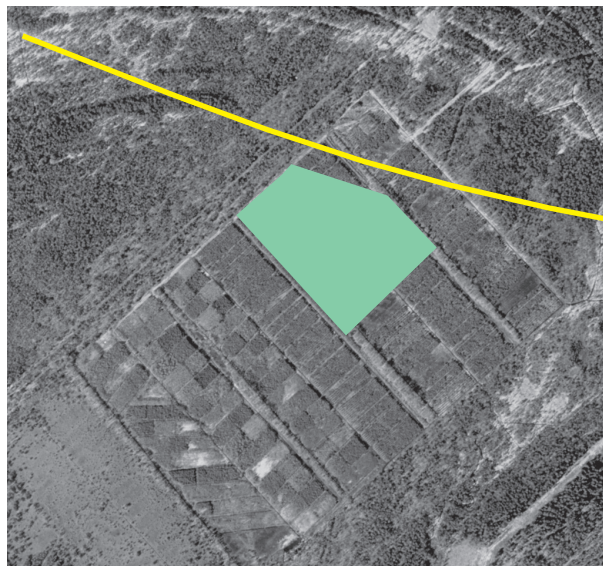
Upplag av torvmassor inom två parceller på Flakmossen. Gul linje markerar mittlinjen för ny E18. Mellan ny E18 och upplaget föreslås en vegetationsridå.
