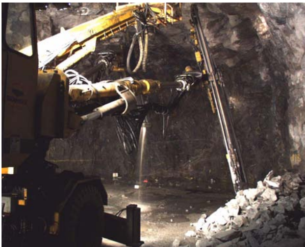
Bergborrningen är till stor del automatiserad.
