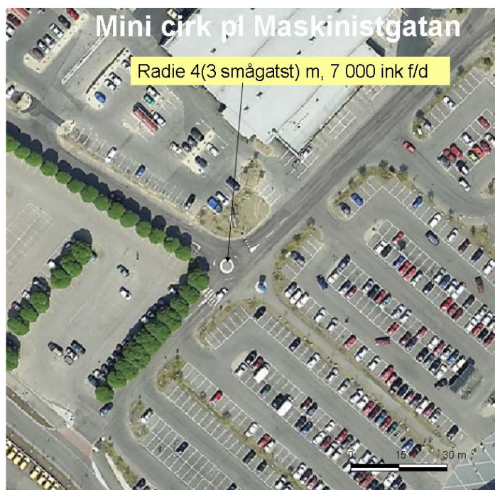
Figur 26 Minicirkulationen vid Maskinistgatans östra ände. Rondellens dimensioner beskrivs såsom Yttre(inre) radie. Foto: Borlänge Energi
