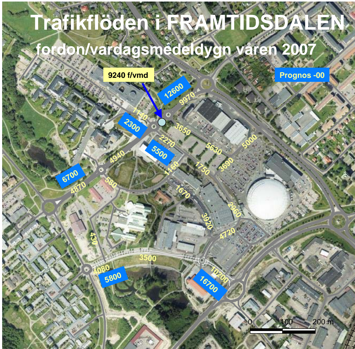
Figur 3 Trafikflöden i Framtidsdalen, jämförelse mellan våren 2007 och prognos vid färdigbyggnad.
