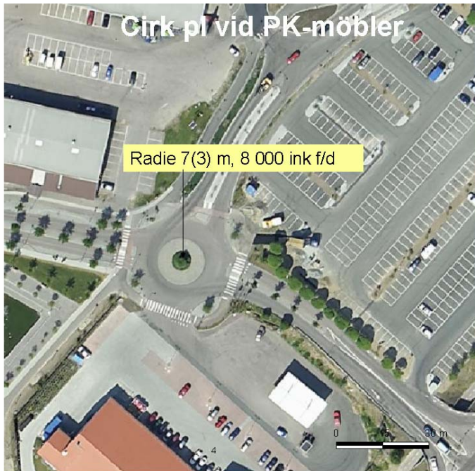
Figur 25 Cirkulationsplatsen vid Dammgatans korsning med Humanistgatan. Rondellens dimensioner beskrivs såsom Yttre(inre) radie.
