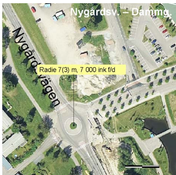
Figur 24 Cirkulationsplatsen vid Dammgatans korsning med Nygårdsvägen. Rondellens dimensioner beskrivs såsom Yttre(inre) radie. Foto: Borlänge Energi
